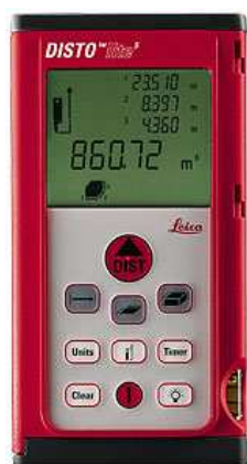
Rysunek 3.15 i Tabela 3.5: Dalmierz laserowy Leica DISTO Lite5
