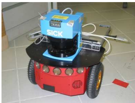
Rysunek 1.4: Pojazd Pioneer wyposażony w lidar firmy SICK połączony z komputerem osobistym
